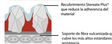
Recubrimiento Stereate Plus\* que reduce la adherencia del material
